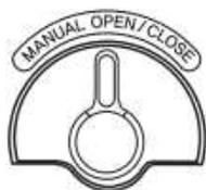
Mude a alavanca de abertura e fechamento manual da fechadura para esquerda ou direita.
